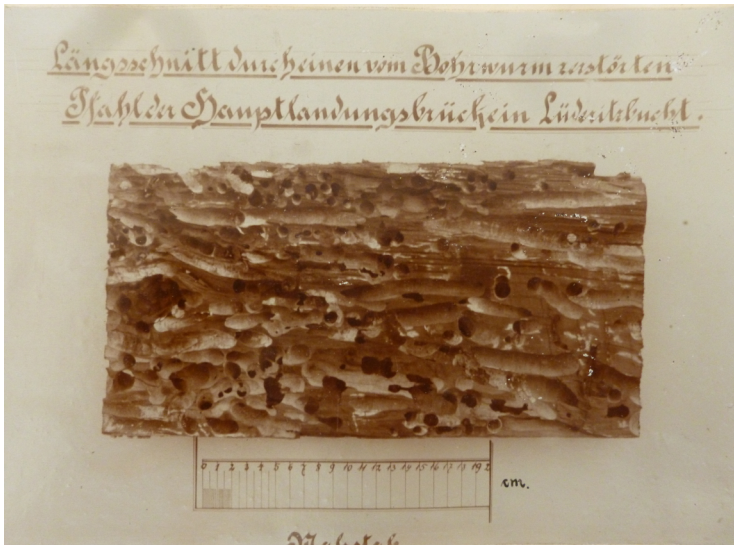
Figure 6.2. “Longitudinal cut through a beam of the main jetty destroyed by the shipworm,” NAN, ZBU 1762 T.VII.G I (vol 2), “Denkschrift über den Neubau der Hauptlandungsbrücke und die weitere Behandlung der Hafenerfrage in Lüderitzbucht,” April 1908, courtesy of the National Archives Windhoek.
